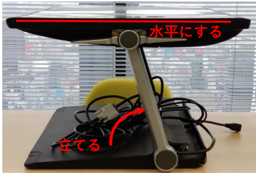
写真11 スタンド固定状態
